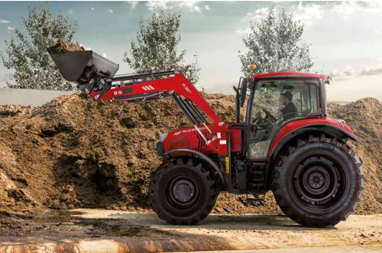
Der Frontlader M30 ist perfekt auf den Traktor **X6** abgestimmt. Er ist aus HLE-Stahl (hohe Elastizitätsgrenze) hergestellt, einem Material, das aufgrund seiner mechanischen Eigenschaften hohen Belastungen standhält. Die Bedienung des Frontladers erfolgt intuitiv über den bequemen Multifunktions-Joystick. Die Stärke des Frontladers M30 sind folgende:
