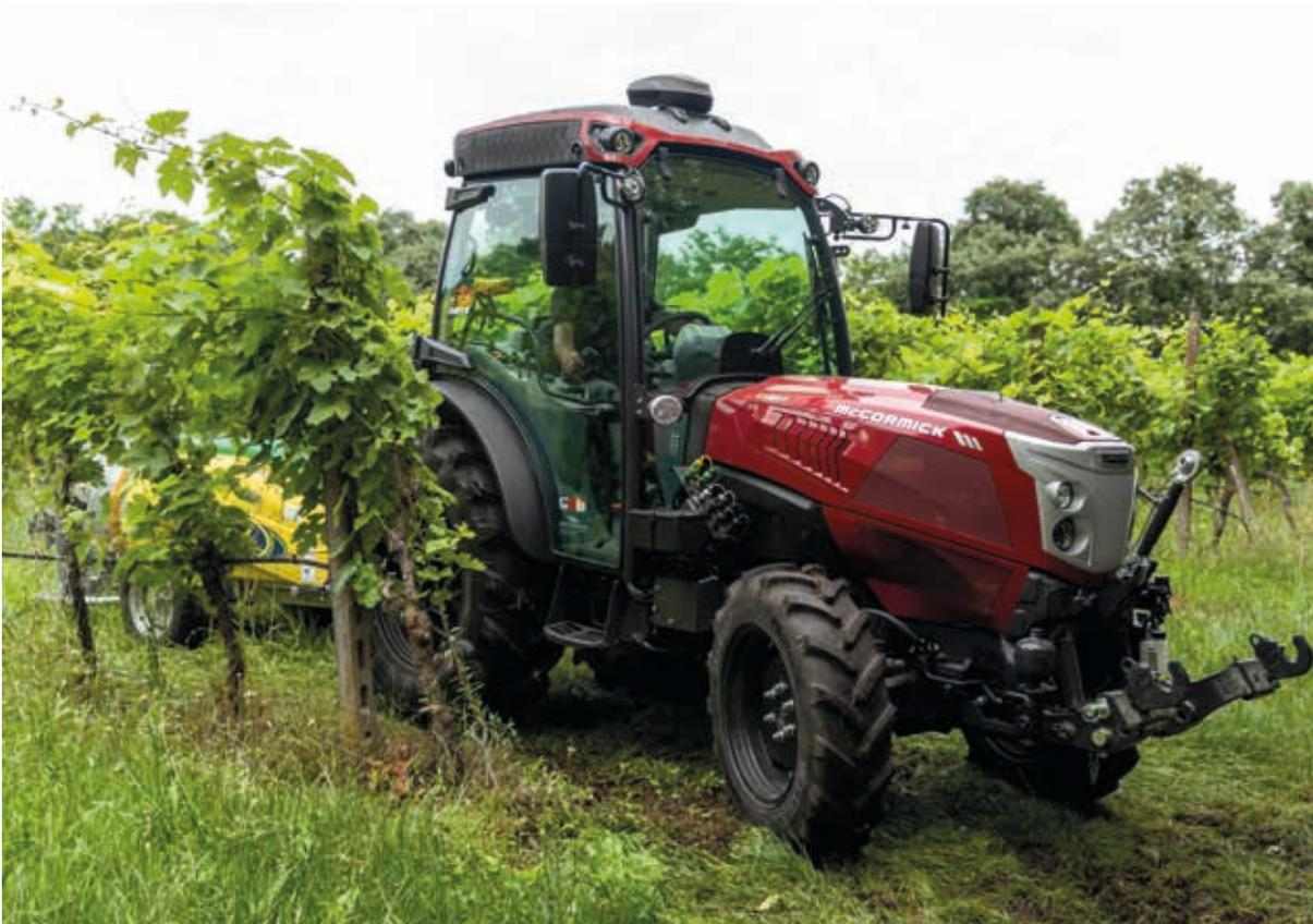
Die Modelle F, N und XL können mit einer gefederten Vorderachse für mehr Stabilität und Wendigkeit ausgestattet werden. Die gefederte Achse verleiht dem **X4F** selbst in unwegsamem Gelände eine optimale Bodenhaftung. Auf dem Feld werden sowohl die Traktion als auch die Kontrolle des Traktors verbessert, während bei Transportarbeiten Geschwindigkeit, Sicherheit und Bedienerkomfort erhöht werden.
